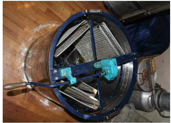
Şəkil 1.5. Bal süzmə aparatı
