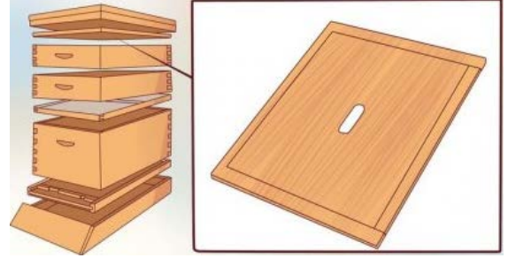
Şəkil 2.8. Üfüqi ayırıcı
