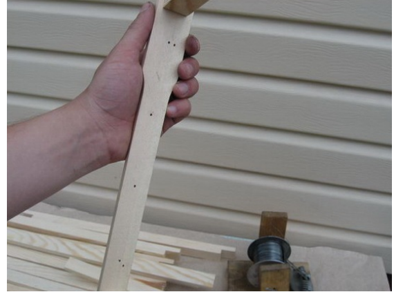
Şəkil 3.20. Deşilmiş çərçivə lövhəsi
