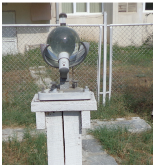
Şəkil 1.12. Heliograf – günəşli saatların miqdarını ölçən cihaz
