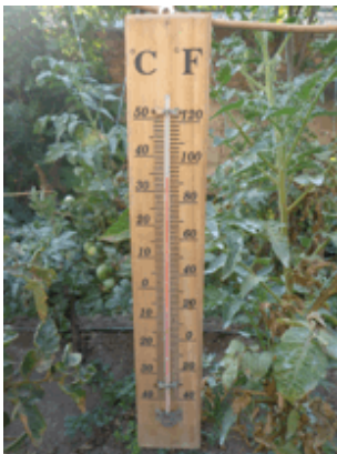
Şəkil 1.2. Havanın temperaturunu ölçən cıvəli termometr
