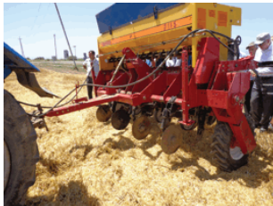
Şəkil 5.6. Şumsuz səpin maşını (no till-sıfır becərmə)
