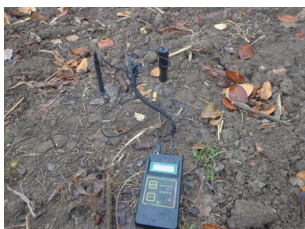
Şəkil 2.6. Elektron cihazla torpağın temperaturunun və nəmliyinin ölçülməsi
