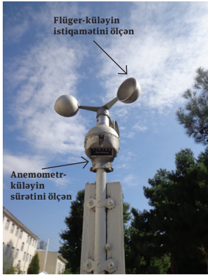
Şəkil 1.10. Küləyin istiqamətini və sürətini ölçən qurğu
