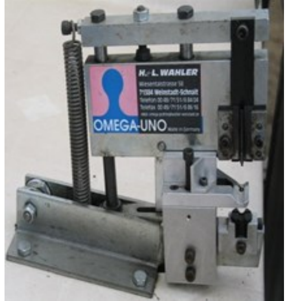
Şəkil 5.35. Stasionar calaqlar masasına bərkidilən calaqlar qurğusu
