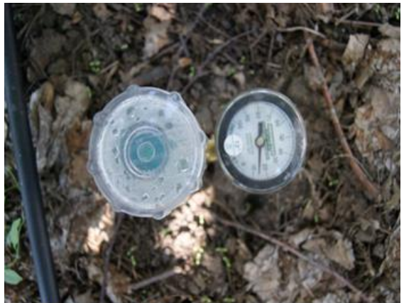
Şəkil 3.10. Nəmliyi ölçmək üçün tenziometr
