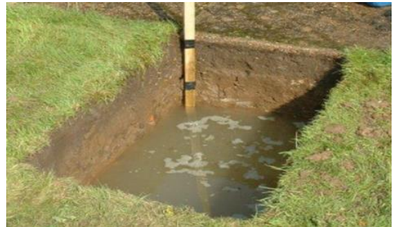
Şəkil 3.8. Qrunt sularının səviyyəsinin ölçülməsi
