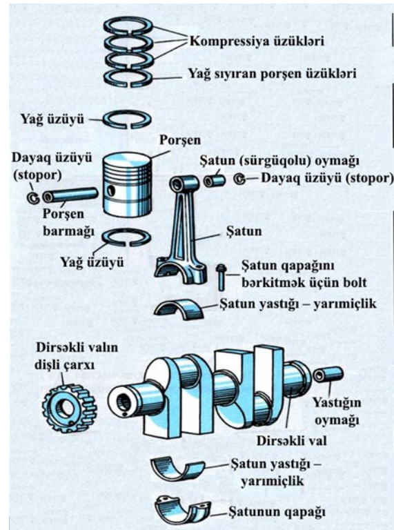
Şəkil 5. Porşen-sürgüqolu qrupu; dirsəkli val
