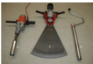
Şəkil 8. Senaj və ya silosdan nümunə götürmək üçün avadanlıq və nümunə götürülməsi (2 - Burğu silindri; 3 - Elektrik silos kəsici; 4 - Silos burğu aləti)
