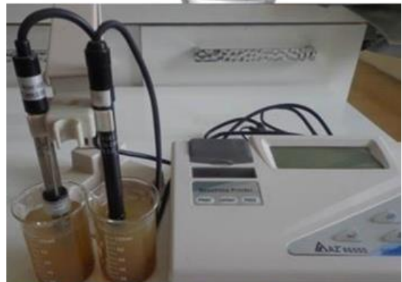
Şəkil 2.16. Məhlulda pH və EC ölçən elektron cihaz
