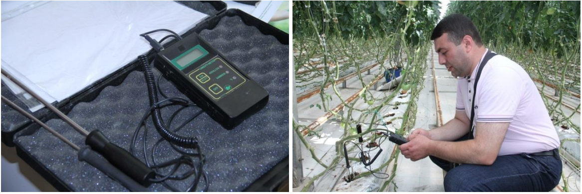
Şəkil 2.13. Torpaq və substratın (hidroponikada) nəmliyinin təyini
