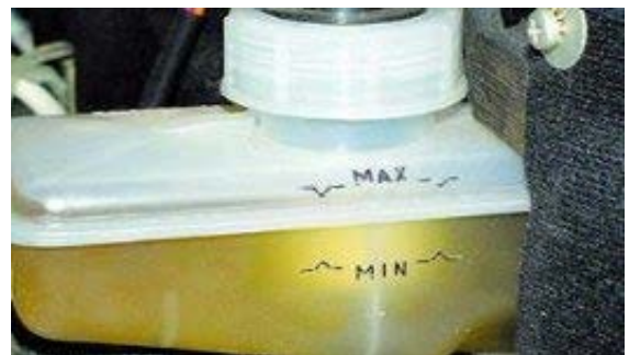
Şəkil 5.7. Əyləc sisteminin başokunda mayenin səviyyəsinin yoxlanılması
