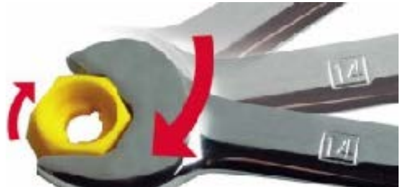
Şəkil 7.16. Açarların bolt və qaykanın ölçüsünə uyğun seçilməsi
