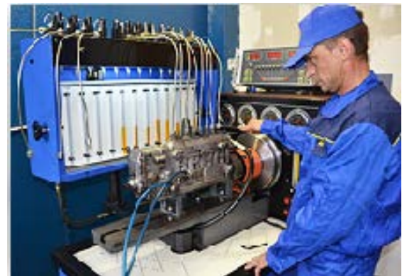
Şəkil 1.22. Yanacaq nasosunun stenddə nizamlanması
