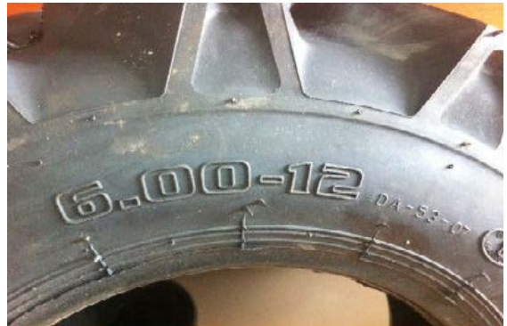
Şəkil 5.4. Şinin yan tərəfində göstərilən ölçülər
