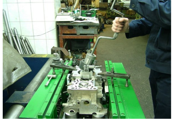
Şəkil 7.21. Mühərriklərin silindrlər blokunun təmiri zamanı xüsusi tərtibatlardan istifadə
