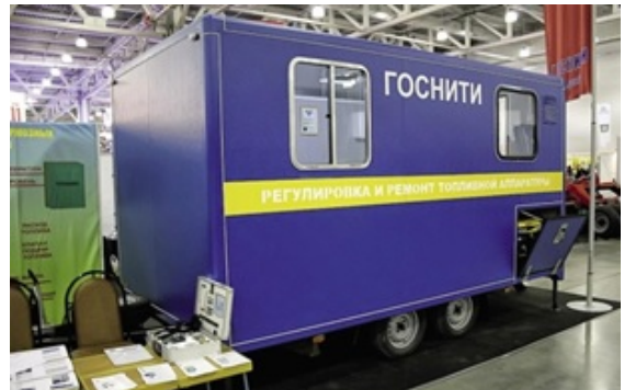
Şəkil 7.12. Diagnostika və nizamlama işləri üçün qoşma laboratoriya
