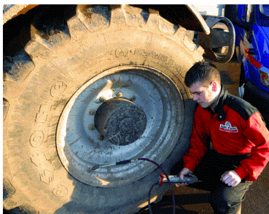
Şəkil 6.18. Şinlərdə havanın təzyiqinin yoxlanılması
