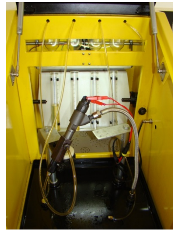
Şəkil 7.22. Dizel mühərriklərinin forsunkaları xüsusi stenddə yoxlanılmalı, yuyulmalı və tənzimlənməlidir
