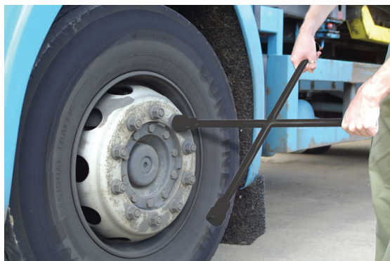
Şəkil 6.17. Təkər disklərinin qaykalarının yoxlanılması
