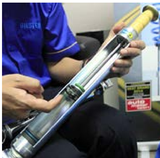
Şəkil 2.26. Qüvvə silindrinin işə yararlılığının yoxlanılması
