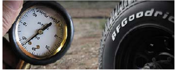
Şəkil 5.16. Şinlərdə havanın təzyiqinin manometrlə ölçülməsi
