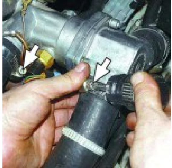
Şəkil 1.31. Soyutma sistemində ventillərin təmizlənməsi
