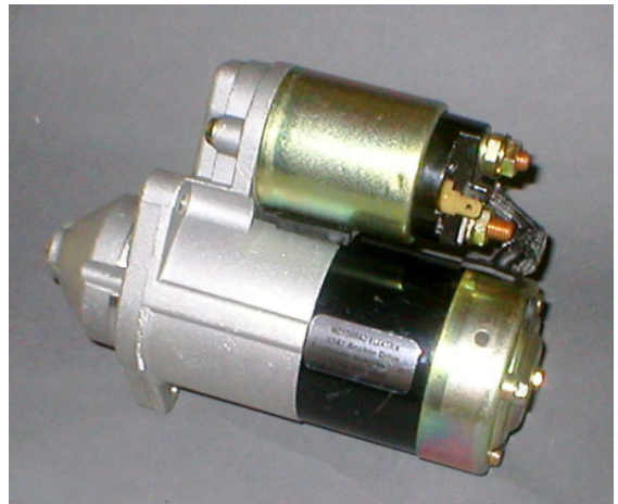
Şəkil 1.32. Starter və işəsalma karbüratorunun mühərriki
