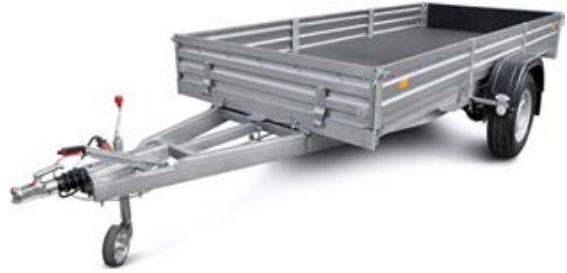
Şəkil 5.9. Ətalətli əyləc sistemli qoşqu
