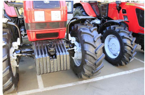
Şəkil 3.7. Belarus 1523 markalı traktora qoyulmuş əks yüklər
