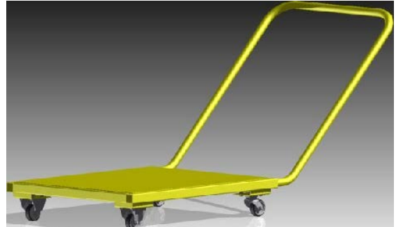
Şəkil 7.19. Hissə və qovşaqların daşınması üçün dayaqlı arabaciq
