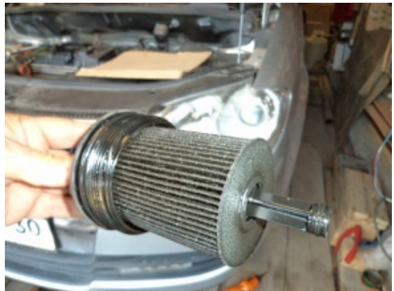
Şəkil 2.23. Sökülmüş süzgəcin yoxlanılması
