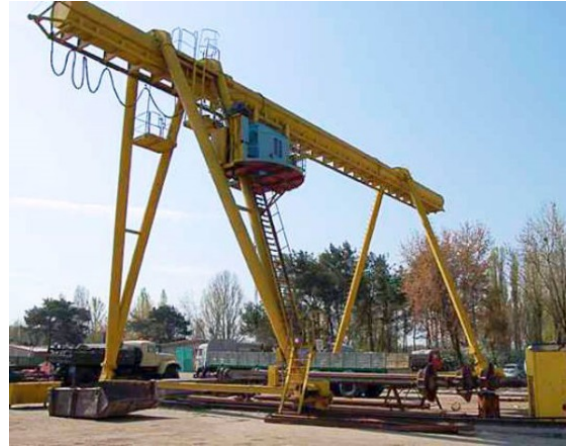
Şəkil 7.3. Kranla işləyərkən kanatın qırılması təhlükə mənbəyidir
