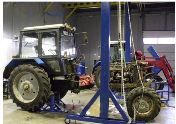
Şəkil 7.6. Təmir və xidmət zamanı emalatxananın telfer kranından istifadə
