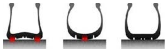
Şəkil 6.16. Hava təzyiqindən asılı olaraq şinlərin profili (1, 2, 3)
