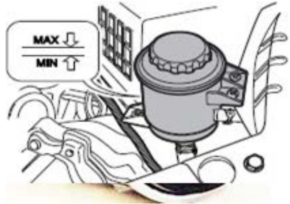
Şəkil 2.11. Hidravlik rul sistemində yağın səviyyəsinin yoxlanması
