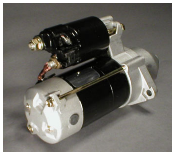
Səkil 4.14. Elektrik starteri
