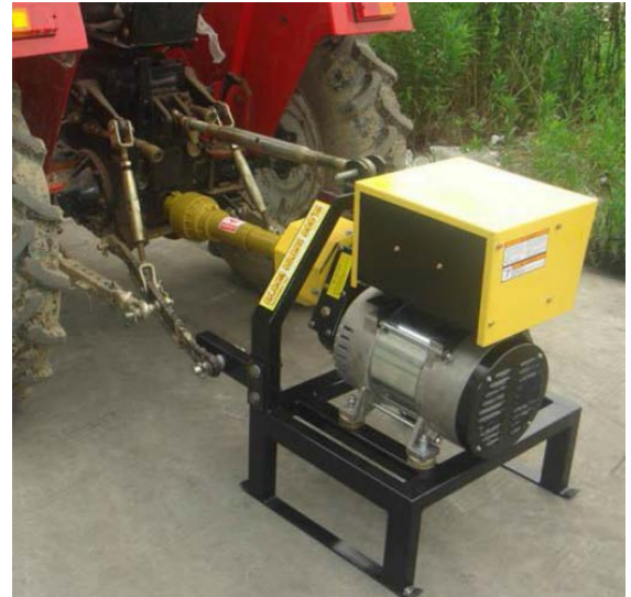
Şəkil 4.10. Traktorun güc ayırıcı valından hərəkətə gətirilən generator
