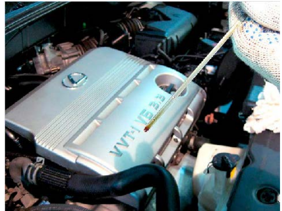
Şəkil 1.9. Mühərrikdə yağın səviyyəsinin yoxlanması
