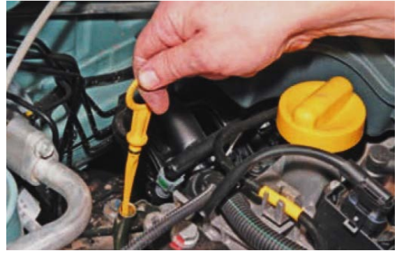
Şəkil 2.16. Hidrosistemin çənində yağın səviyyəsinin yoxlanması
