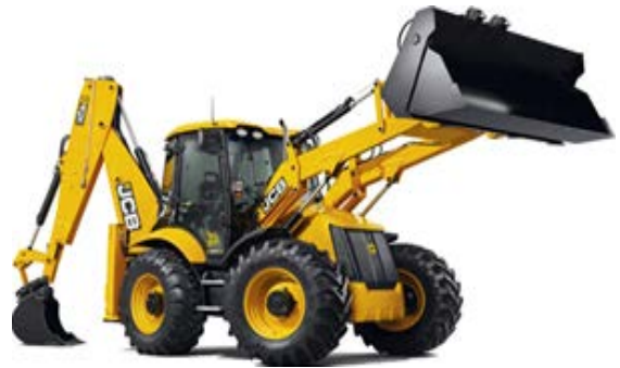
Şəkil 3.28. Qabaq hissəsi ilə də yükqaldıran ekskavator
