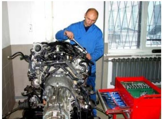
Şəkil 7.15. Mühərrikin sönmüş vəziyyətində ona texniki xidmətin göstərilməsi
