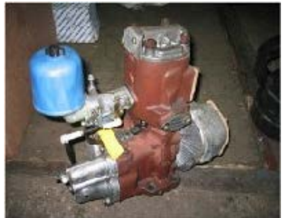
Şəkil 1.33. Dizel mühərrikinin karbüratorlu mühərriklə işə salınması
