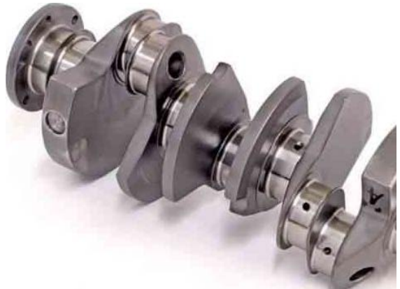
Şəkil 3.38. Mühərrikin dirsəkli valında yeyilmədən əsas və sürgüqolu boyunlarında araboşluqları əmələ gələ bilər
