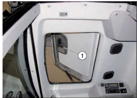
Şəkil 2.9. Aqreqatın işi zamanı kabinənin havalandırılması sistemi
