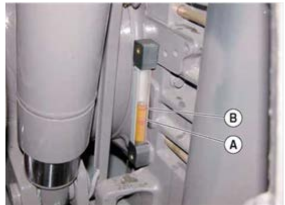
Şəkil 2.16. "Class Axion 820" traktorunun hidravlik asma sistemində yağın minimum və maksimum səviyyəsi
