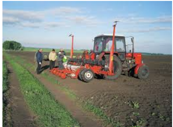
Şəkil 1.19. Traktora qoşulmuş toxumsəpənin səpici aparatına toxumun doldurulması
