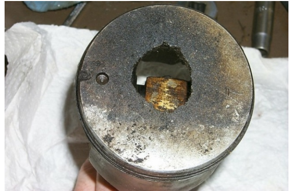
Şəkil 3.37. Detonasiya nəticəsində porşenin deşilməsi baş verə bilər
