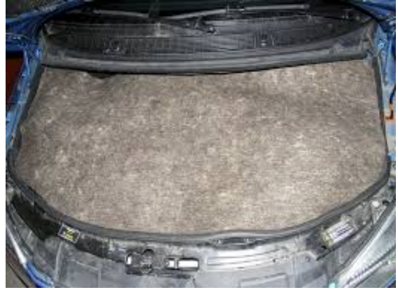
Şəkil 4.27. Mühərrikin şaxtadan qorunması üçün xüsusi örtükdən istifadə edilməsi
