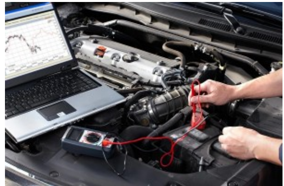
Şəkil 2.14. Starterin işə yararlılığının voltmetrlə yoxlanılması
