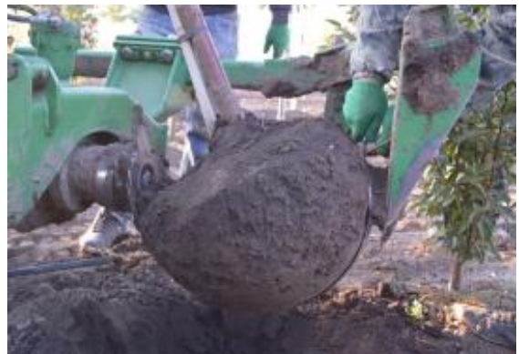
Şəkil 4.14. Texnikanın işçi orqanlarına torpağın yapışması
