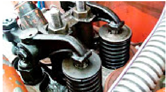
Şəkil 3.43. Qazpaylama mexanizminin klapanlarının nizamlığının pozulması nəticəsində səs yaranır
