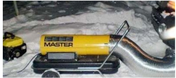
Şəkil 4.28. Şaxtada mühərrikin işə salınması zamanı istifadə edilən xüsusi qurğu
