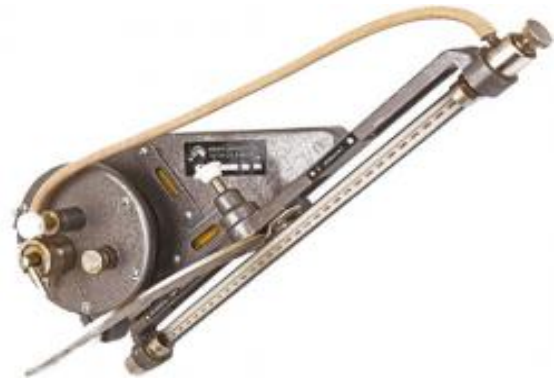
Şəkil 3.31. Kabinada yağın səviyyəsini ölçən mikromanometr
