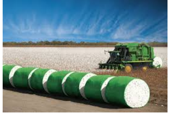
Şəkil 3.30. John Deere JD 690 markalı 6 cərgəli pambıqyığan kombaynla pambığın rulonlu kiplərlə toplanması
