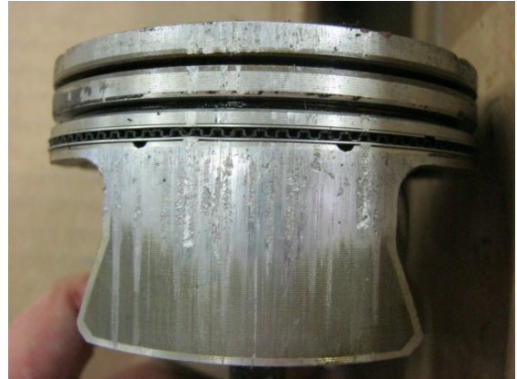
Şəkil 3.42. Porşenin halqalarının yeyilməsi ixrac qazlarında iyn əmələ gəlməsinə səbəb olur
