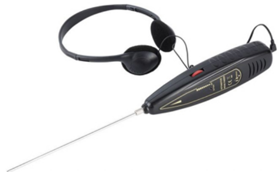
Şəkil 3.40. Nasazlığı səsə görə müəyyən edən stetoskop
