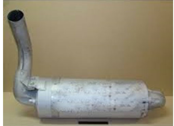
Şəkil 1.30. Aqreqatı işi zamanı yanğın törədən hissələr
