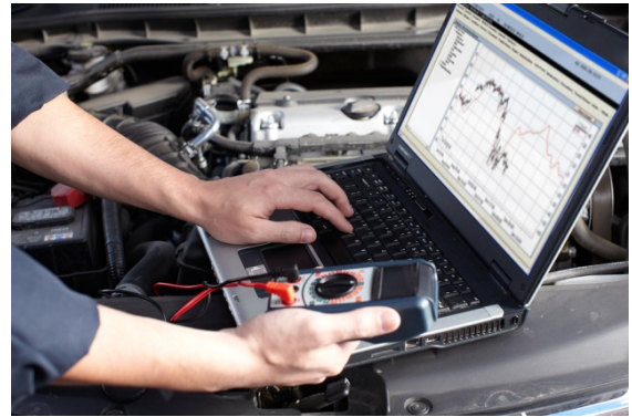
Şəkil 2.11. Traktorun elektrik avadanlıqlarının testerlə diaqnostika edilməsi və işə yararlığının yoxlanılması
