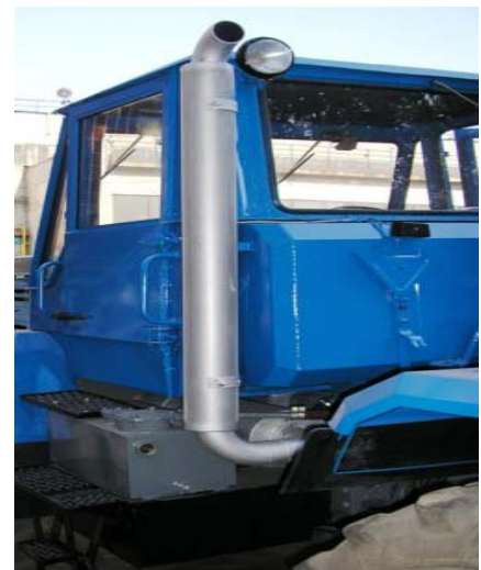
Şəkil 3.44. Mühərrikin yanmış qaz ötürücü trubası
