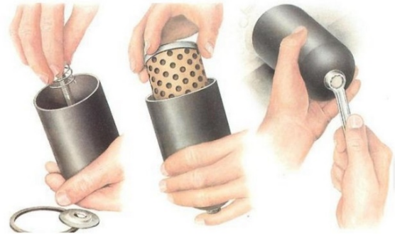
Şəkil 2.8. Hidravlik sistemdə yağ süzgəcinin dəyişdirilməsi
