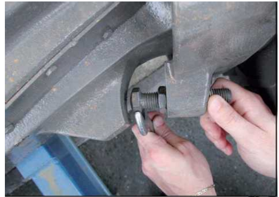
Şəkil 2.21. Traktorun dönmə hərəkətinin məhdudlaşdırıcısının tənzimlənməsi
