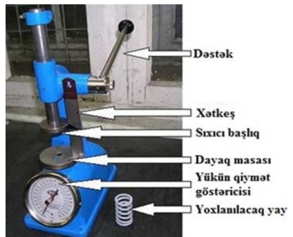
Şəkil 1.13. Klapın yayının elastikliyin yoxlanması
