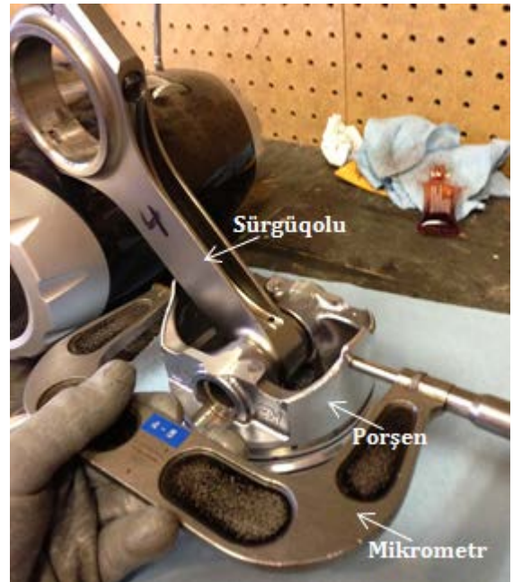
Şəkil 1.1. Porşenin yeyilməsinin yoxlanılması
