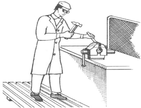
Şəkil 4.18. İşkanə ilə metalın çapılması işinin düzgün yerinə yetirilməsi
