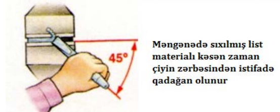
Şəkil 6.45. İşin növündən asılı olaraq zərbələrdən istifadə
