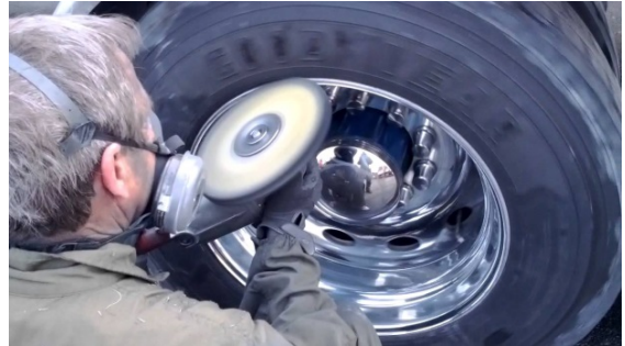
Şəkil 2.38. Pardaqlama işi
