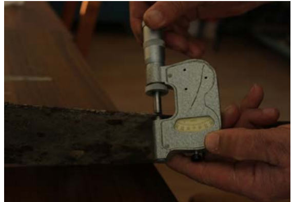
Şəkil 1.21. Gavahının yeyilməyə yoxlanılması
