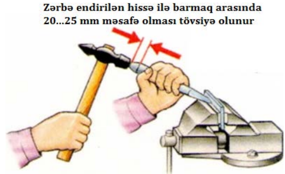
Şəkil 6.46. Məngənədə sıxılmış hissənin zübillə təhlükəsiz kəsilməsi
