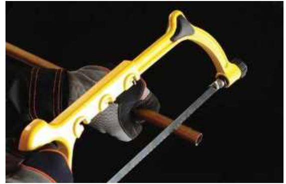
Şəkil 4.29. Metal borunun bıçqı ilə kəsilməsi
