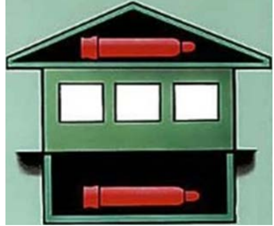
Şəkil 6.40. Asetilen balonlarının təhlükə yarada biləcək (zirzəmi və talvar altında) yerdə saxlanması
