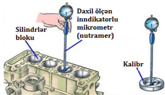
Şəkil 1.5. Silindrin daxili diametrinin ölçülməsi
