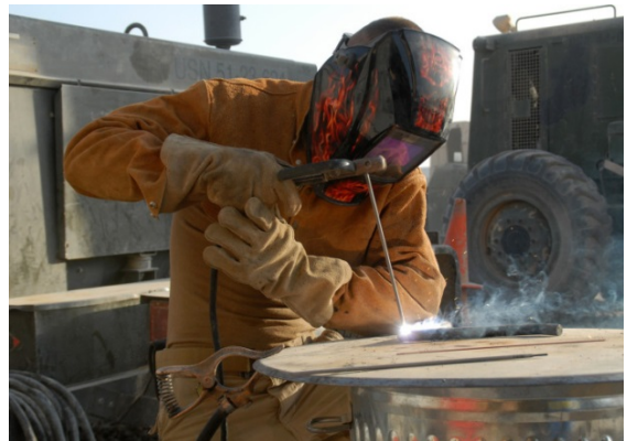
Şəkil 6.22. Elektrik qaynağı
