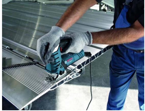
Şəkil 4.31. Elektrolobzıqla metalın kəsilməsi
