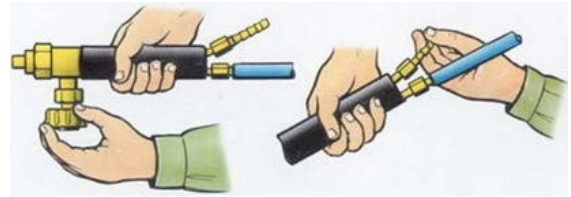
Şəkil 3.16. Qazqarışdırıcının asetilen borusunun işə hazırlığının yoxlanılması
