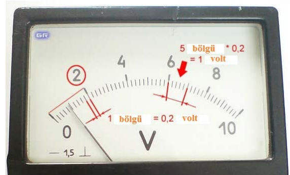
Şəkil 4.49. Voltmetrin bölgüləri üzrə ölçmənin hesablanması
