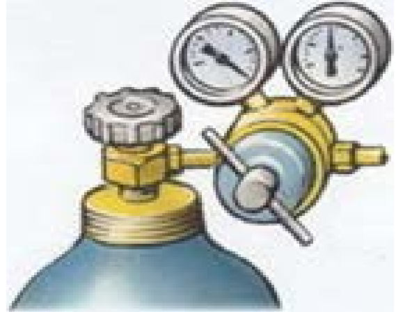
Şəkil 3.18. Balondan verilən qazın təzyiqinin nizamlanması
