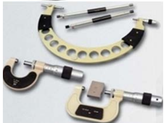
Şəkil 1.25. Müxtəlif ölçü həddli mikrometrlər
