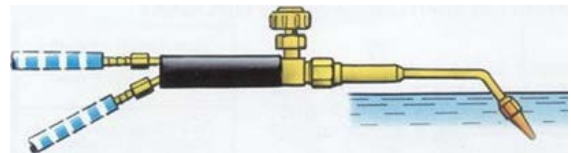
Şəkil 3.17. Qazqarışdırıcının qaz buraxmamasının yoxlanılması
