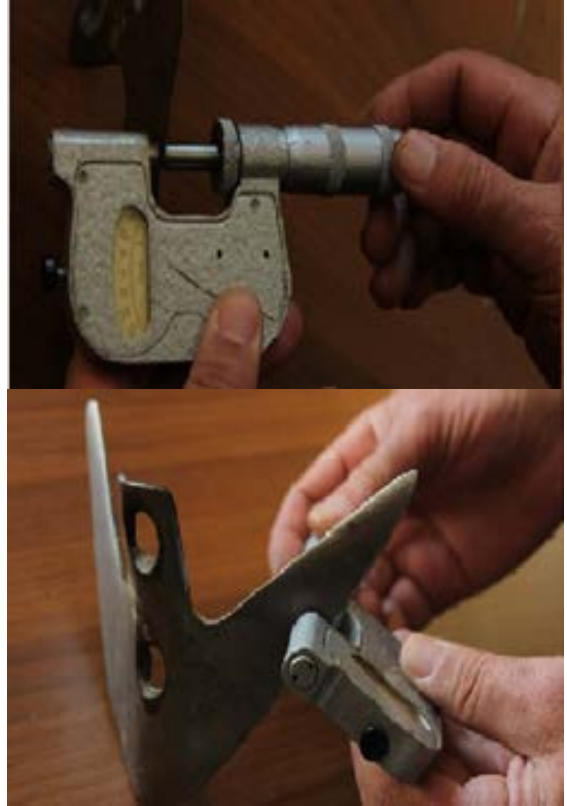
Şəkil 1.22. Kultivator pəncələrinin yeyilməyə yoxlanması
