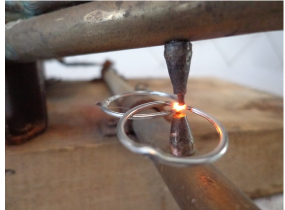
Şəkil 3.11. Baş-baş qaynağın sxemi
