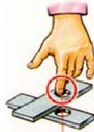
Şəkil 6.12. Deşiklərin uyğunluğunun yoxlanılması barmaq ilə yoxlanılır
