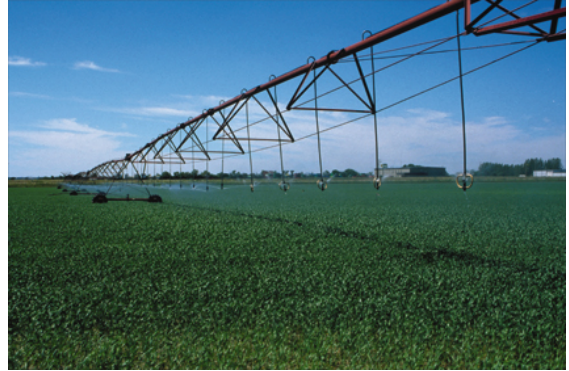
Şəkil 4.22. Pambıq tarlasında süni yağışyağdırma qurğusu
