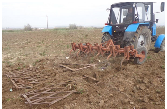
Şəkil 3.7. Bir gedişdə torpağın yumşaldılması və alaq otlarının məhv edilməsi (ziq-zaq mala-ütü-çizel kultivatorla aqrekatlaşmış)
