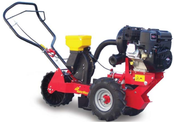
Şəkil 3.24. Əl ilə əkin üçün pnevmatik səpin maşını
