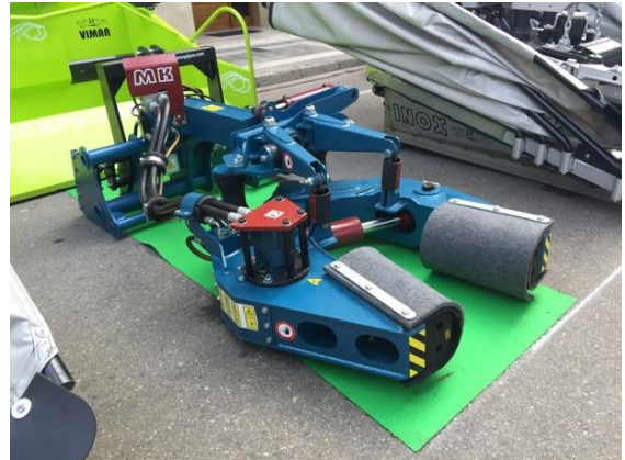
Şəkil 7.1. Cəviz ağaclarını silkələmə üçün hidravlik vibrator
