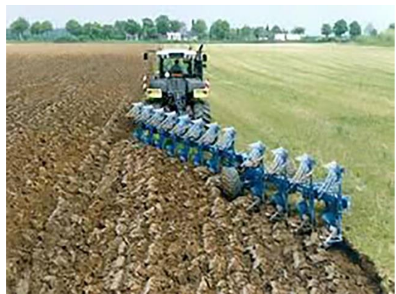
Şəkil 2.5. Müasir kotan və torpağın əsas becərilməsi
