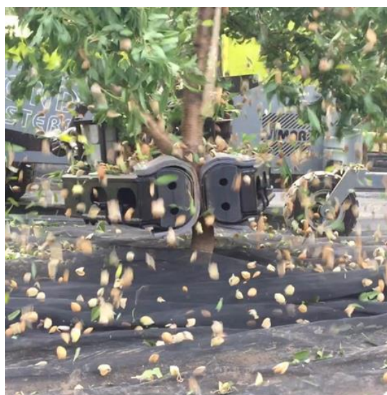
Şəkil 7.3. Bitkinin hidravlik vibratorun köməyi ilə silkələnməsi
