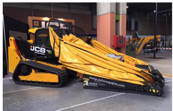
Şəkil 7.2. Qəbuledici çətirə təchiz olunmuş meyvəyığan aqreqat
