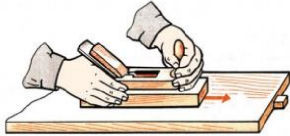
Şəkil 3.12. Rəndələmə qaydası
