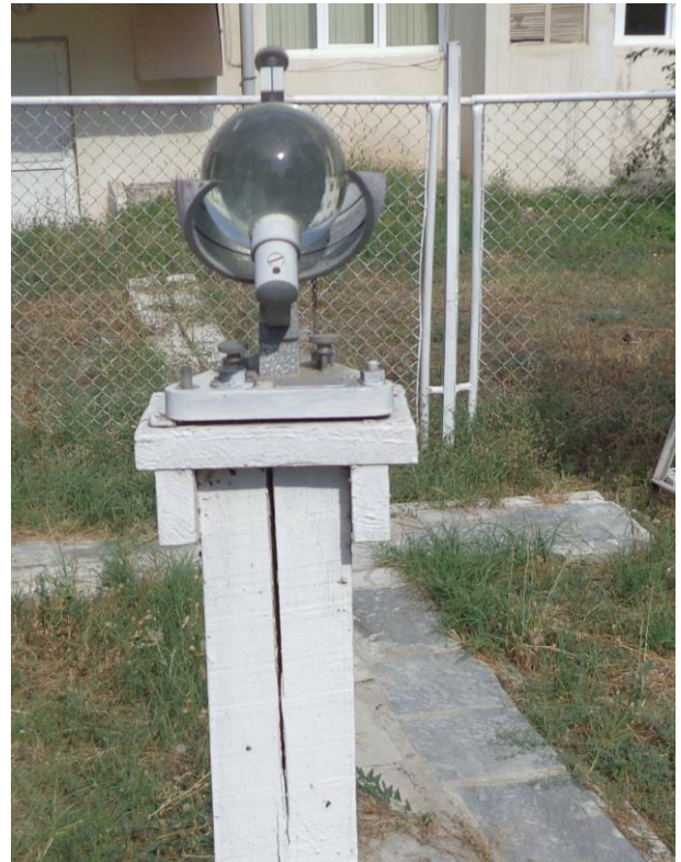
Şəkil 1.12. Heliqraf – günəşli saatların miqdarını ölçən cihaz
