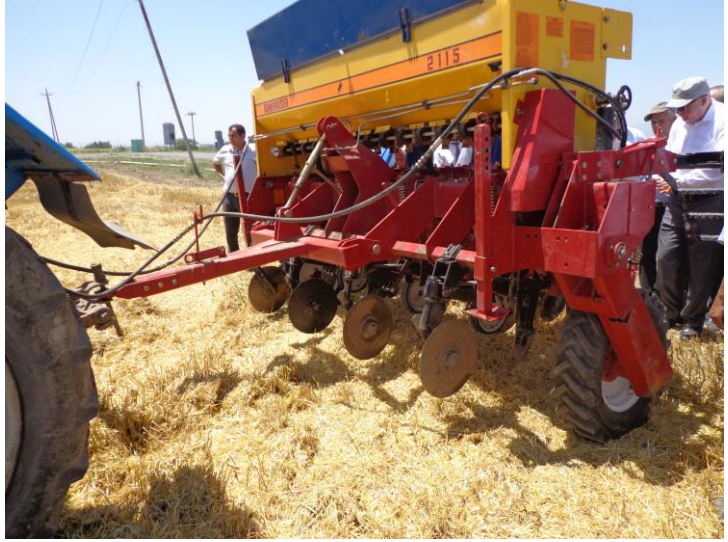
Şəkil 5.6. Şumsuz səpin maşını (no till-sıfır becərmə)
