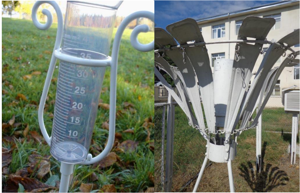
Şəkil 1.8. Yağıntının miqdarını ölçən qablar
