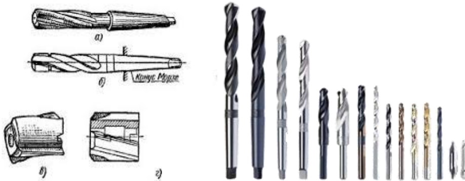
Şəkil 1.5. Burğu işçi və quyruq hissəsi a) spiralvari burğu (iynə); b) burğunun itilənməsinin düzgünlüyünü yoxlamaq üçün şablon
