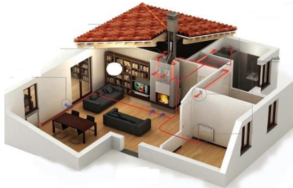
Şəkil 2.5. Süni dövr etmə ilə şaquli birborulu istilik sisteminin sxemi
