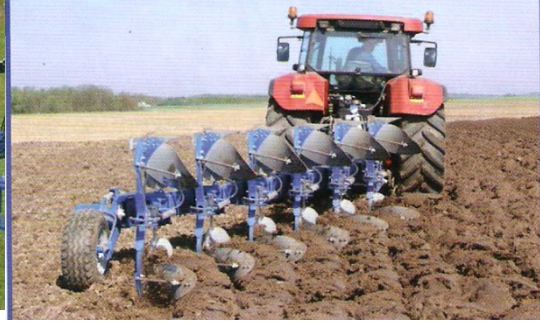
Şəkil 10. Altı Gövdəli iki yaruslu asma kotan traktorla aqreqatlaşmış halda iş zamanı
