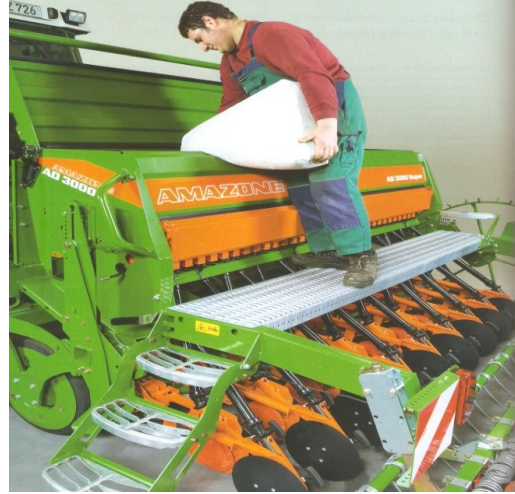
Şəkil 33. Toxumsəpən maşına dən və gübrənin yüklənməsi
