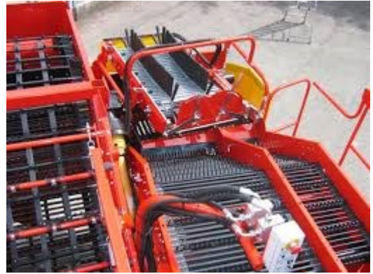
Şəkil 59. Kartofyığan kombaynın işçi orqanı
