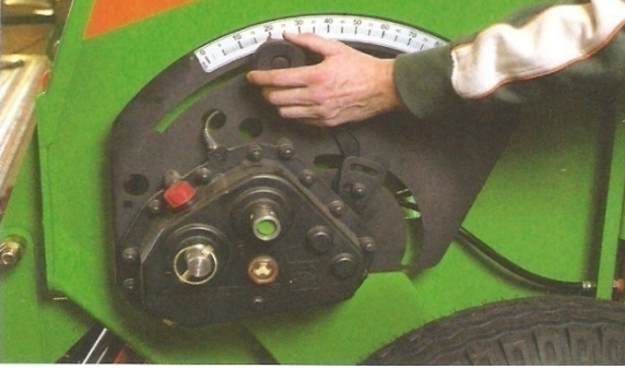
Şəkil 32. Cığıraçanları qaldırma və onların torpağa keçmə dərinliyini tənzimləyən mexanizm
