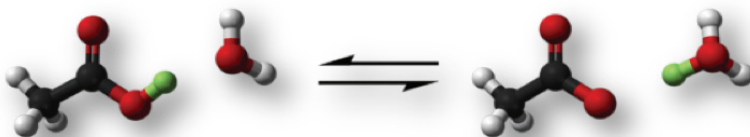
Şəkil 5. Sirkə turşusunun dissosiasiyası nəticəsində asetatın alınması modeli
