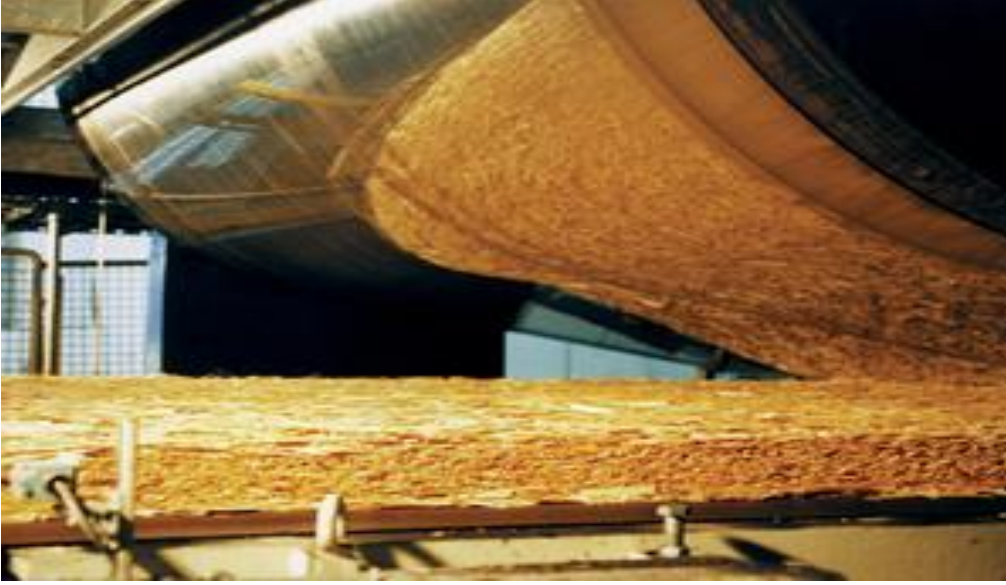
Şəkil 1.7. DSP istehsalı üçün yapışqanın axıdılması
