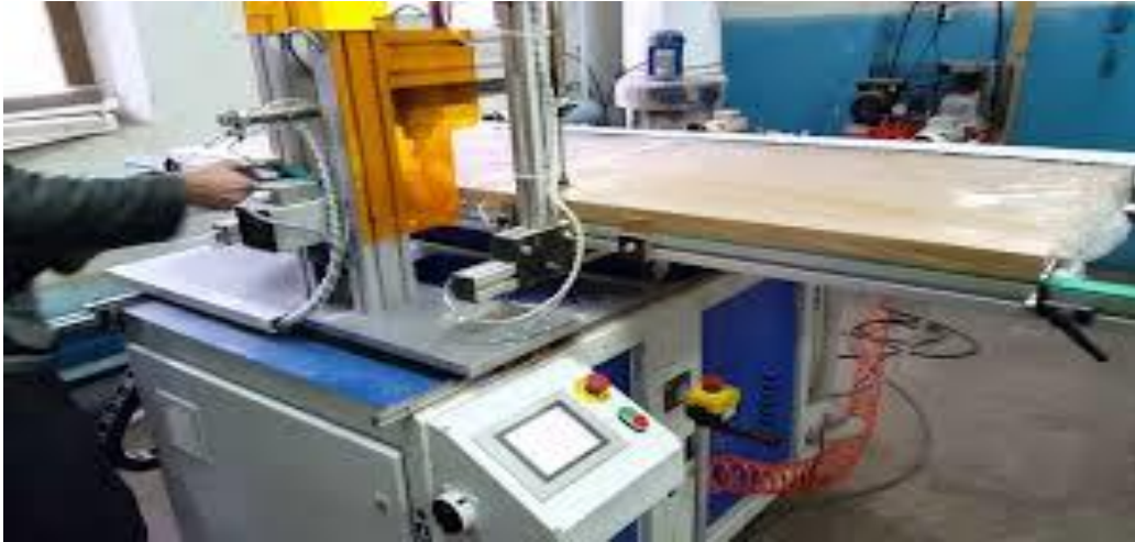
Şəkil 3.19. ÇPU dəzgahında qıfil yerinin açılması
