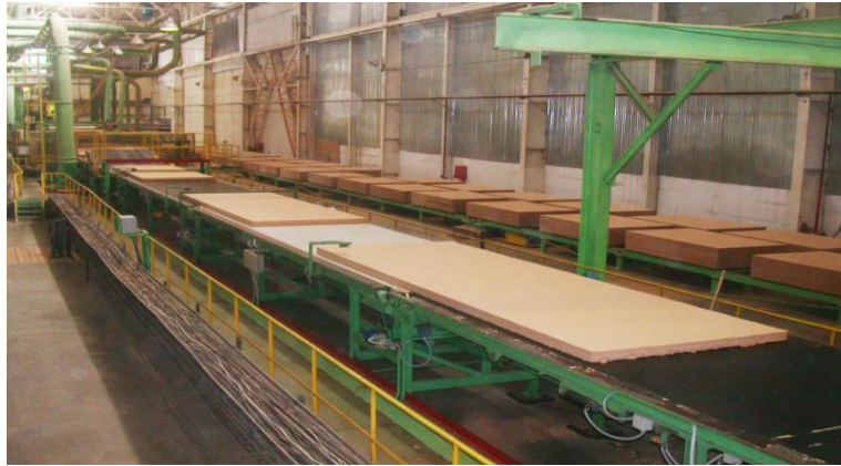
Şəkil 1.4. Faner istehsalı üçün şponların düzülüş qaydası
