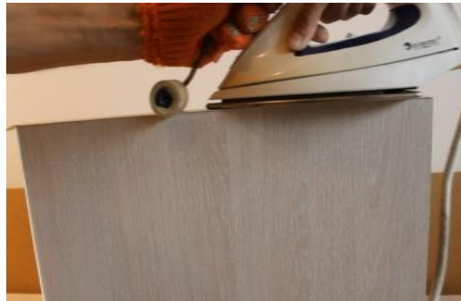
Şəkil 1.16. Ütü vasitəsi ilə bantın yapışdırılması
