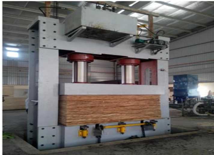
Şəkil 1.2. Faner istehsalı üçün şponların sıxılıb saxlanması
