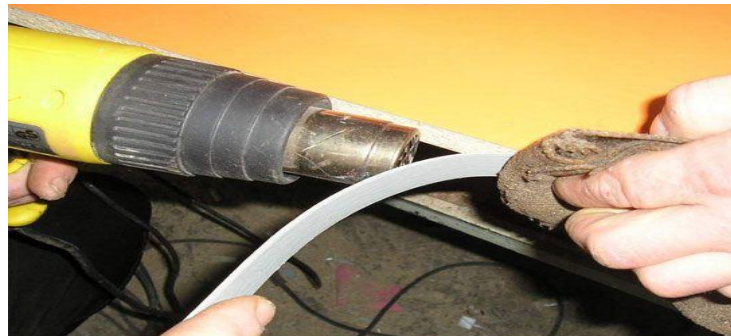
Şəkil 1.21. Fen. Fenlə bantların isidilib yapışdırılması
