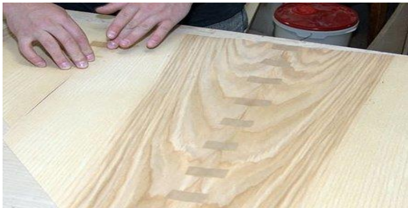
Şəkil 1.27. Ensiz şponların birləşdirilməsi üsulu
