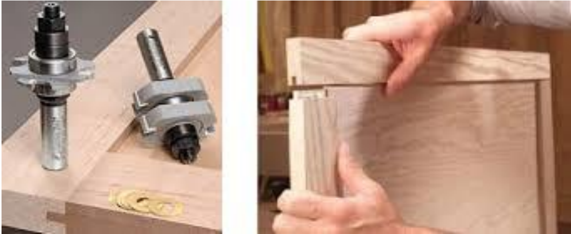
Şəkil 2.10. Mebel qapısının təmiz taxta materialdan yığılması qaydası
