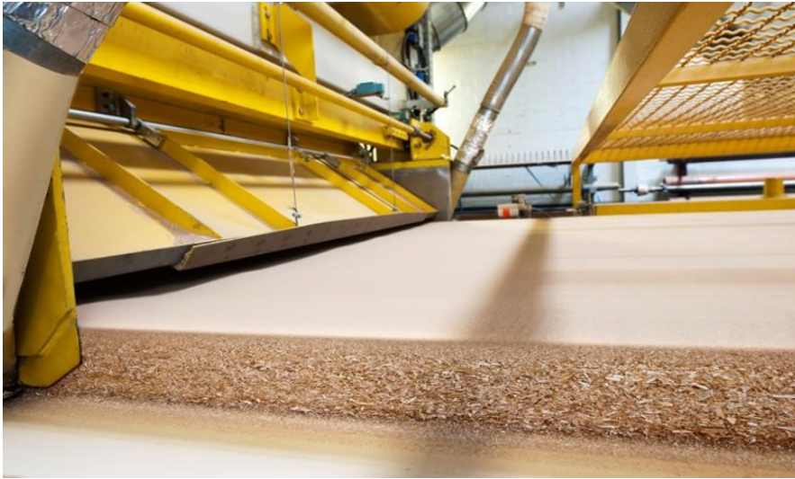
Şəkil 1.9. MDF istehsalı. Xammalın basılma mərhələsi
