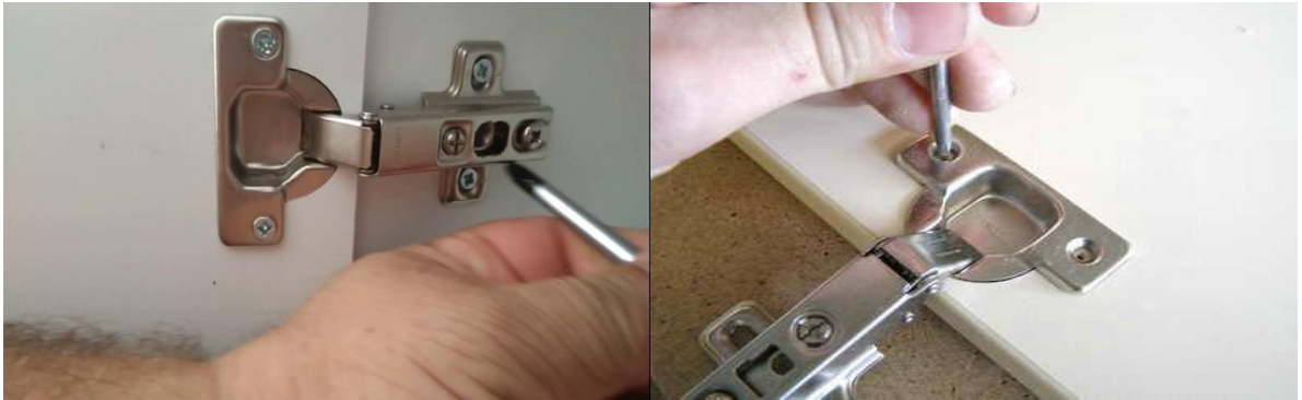
Şəkil 3.23. Mebel qapısının montajı
