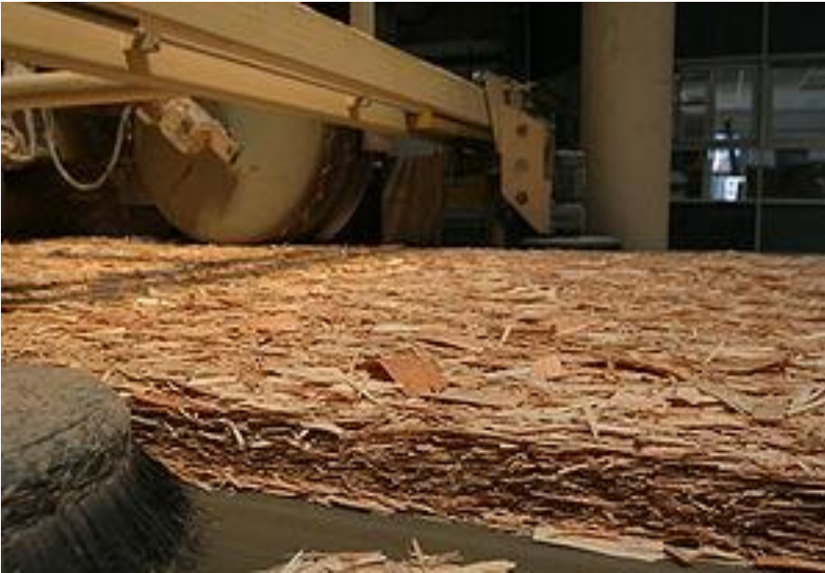
Şəkil 1.6. DSP istehsalı üçün ağacın doğranması
