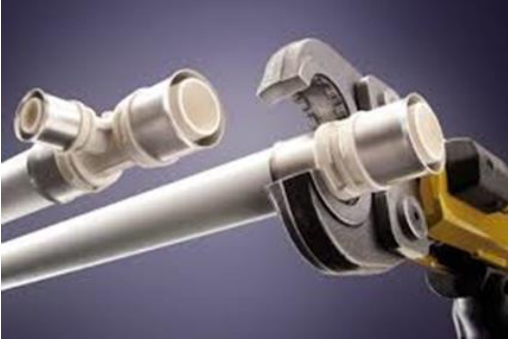
Şəkil 2.16. Press kəlbətindən istifadə etməklə muftanın sıxılması
