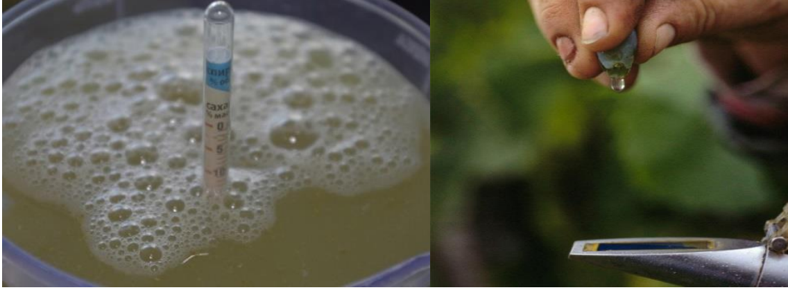
Şəkil 4.3. Texniki yetiškənliyin laborator qaydada yoxlanması
